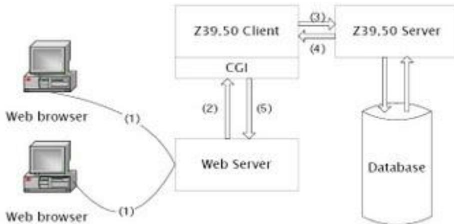
Z39.50 Web gateway示意圖(沈英，2001)
